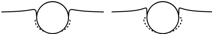
**Рис. 4.** Учет деформации цилиндра при его движении после удара с постоянной скоростью ( $\chi = 1; 0.1$ )
